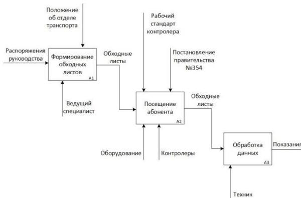
Рисунок 2 – Декомпозиция контекстной диаграммы технологического процесса учета показаний счетчиков электроэнергии АО «Сетевая компания Алтайкрайэнерго» «как есть»
