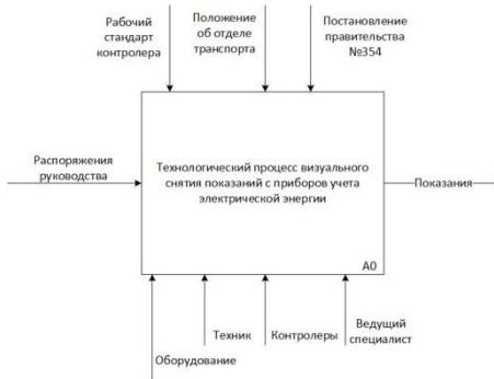
Рисунок 1 – Контекстная диаграмма технологического процесса учета показаний счетчиков электроэнергии АО «Сетевая компания Алтайкрайэнерго» «как есть»
