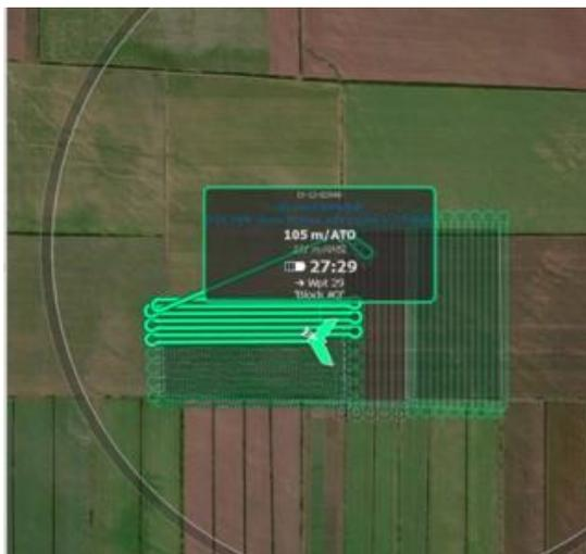
Рисунок 2 - Процесс построения полетного задания в программе “eMotion”
